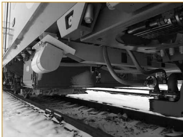
Рис. 5. Система пространственного сканирования
