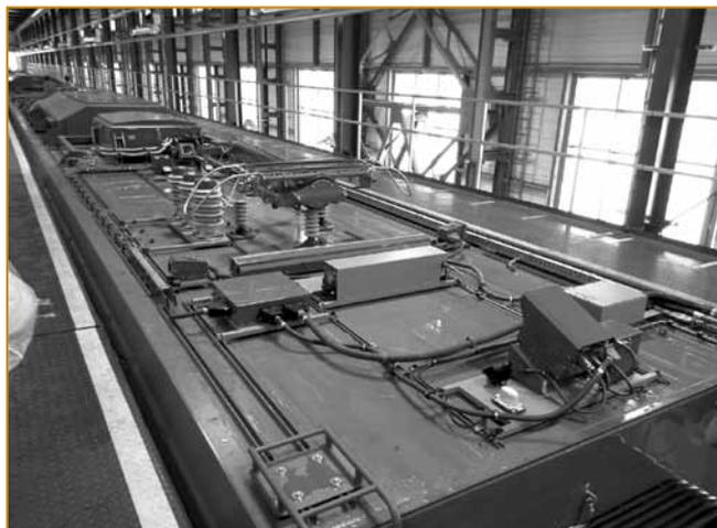
Рис. 4. Система контроля контактной сети
